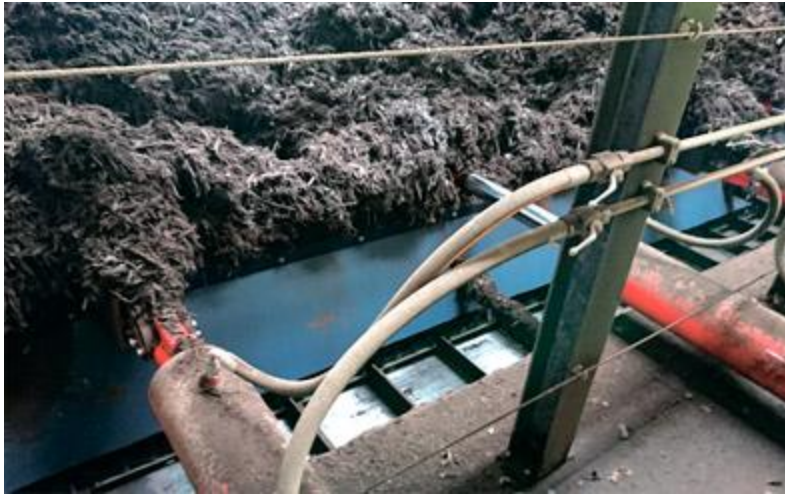
Мульча деревини для сушіння у стрічковій сушарці
