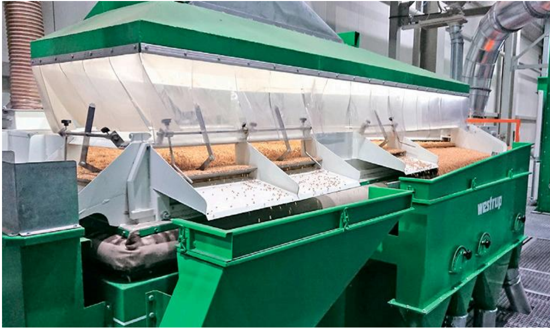
СТОВ «Україна». Гравітаційний сепаратор, модель КА виробництва WESTRUP (Данія)
