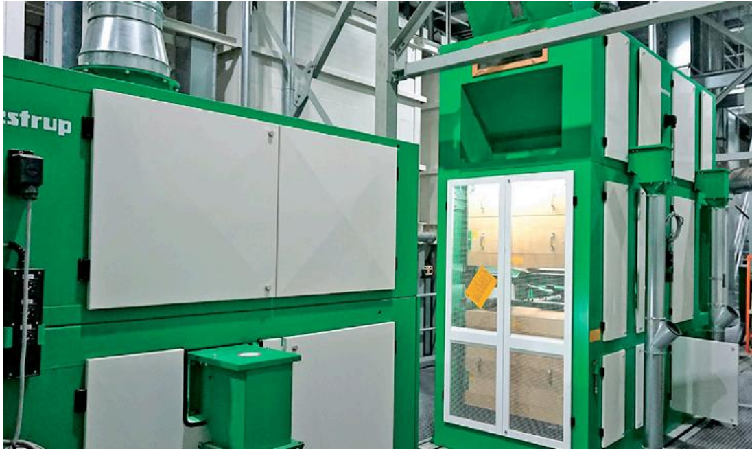
СТОВ «Україна». На передньому плані — машина попереднього очищення, модель SD; далі машина тонкого очищення, модель FP виробництва WESTRUP (Данія)
