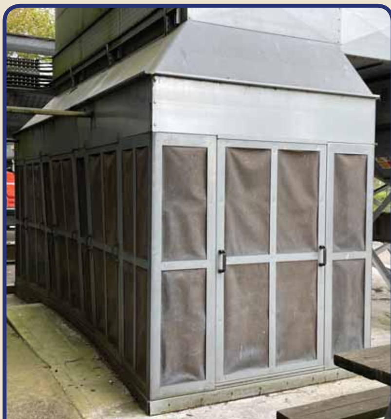
Опціональна сітчаста огорожа топки для експлуатації в дуже брудних умовах для запобігання випадковому займанню
