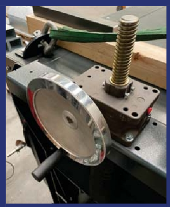
Гвинтовий домкрат для регулювання кроку
