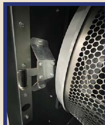
Засувка для фіксації циліндра
