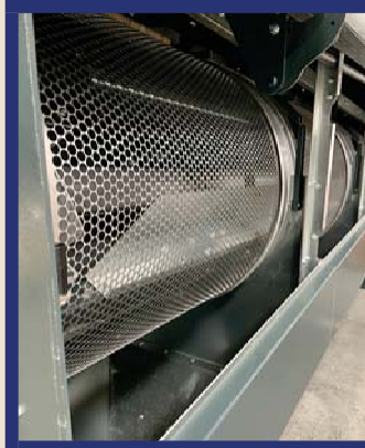
Сита встановлені за допомогою ексцентрикових засувок
