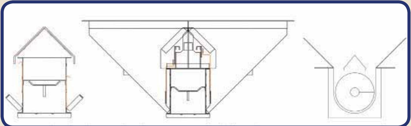
Траншейний приймальний конвеєр, механізований приймальний бункер та шнековий прийом у розрізі.
