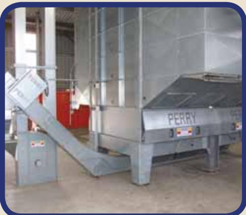
Для забезпечення постійного руху зерна всі зерносушарки серії Savannah оснащені нашим високопродуктивним повністю оцинкованим заслінковим механізмом вивантаження з пневматичним приводом (з втулками із фосфористої бронзи на всіх зношуємих частинах). Пневматичний заслінковий механізм вивантаження забезпечує рівномірний рух культури по всій основі. Це особливо важливо при сушінні культур із дуже високою вологістю, а також насіннєвих культур.
